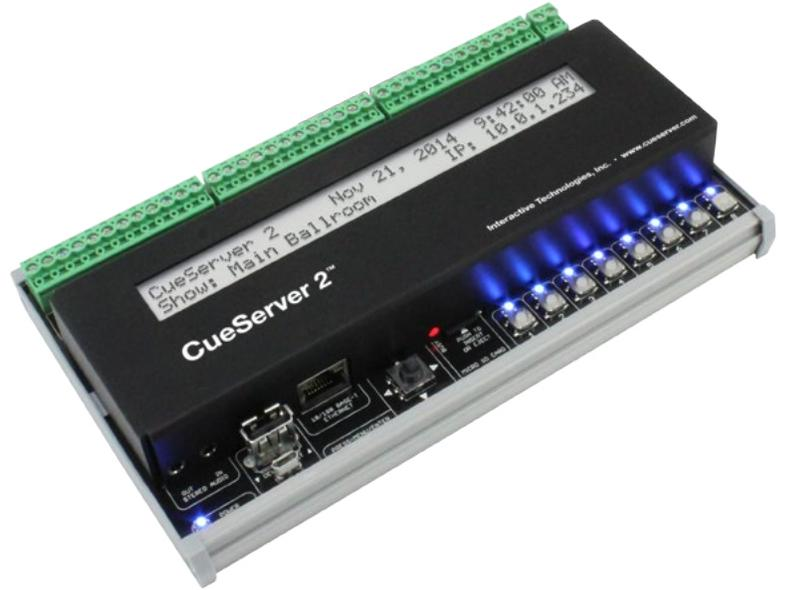
キューサーバーは、エンターテイメントスタイルの照明再生と建築照明コントロールを同時に管理する能力があります。ネットワークされたボタンステーション、LCDタッチスクリーン及びモバイルデバイス用のアプリケーションがキューサーバーの周辺機器としてあります。
